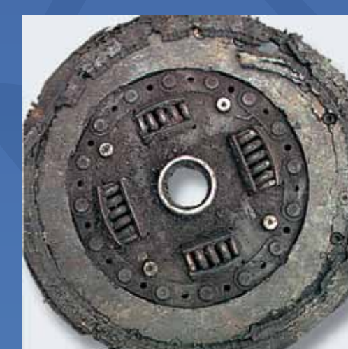
BALATA DE DISCO DAÑADA
