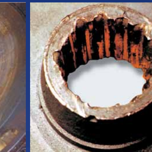
ESTRIAS DEL NÚCLEO DE DISCO DE EMBRAGUE DAÑADAS
