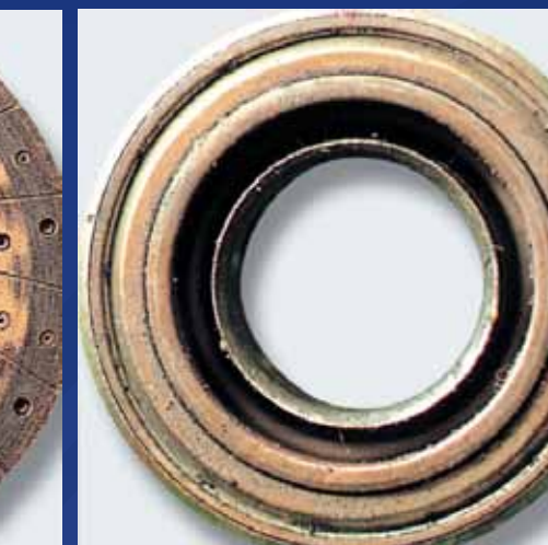
RODAMIENTO DE EMPUJE DAÑADO
