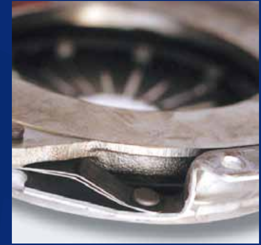
LAINAS DE PRENSA DE EMBRAGUE DAÑADAS
