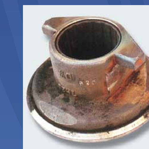
EL PUNTO DE CONTACTO DE LA HORQUILLA ESTÁ DESGASTADO, LA HORQUILLA ESTÁ DESCENTRADA
