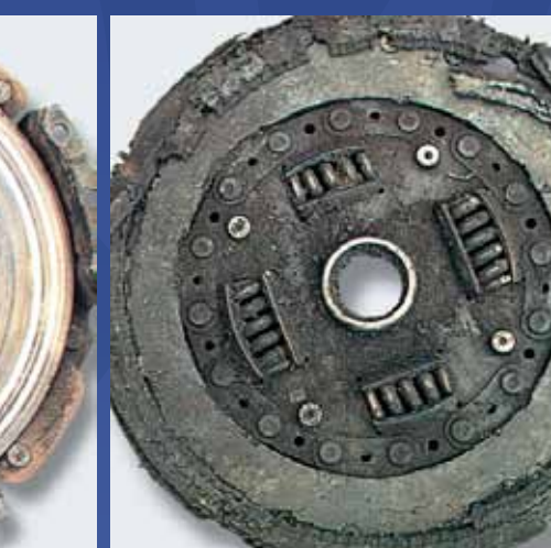
BALATA DE DISCO DAÑADA
